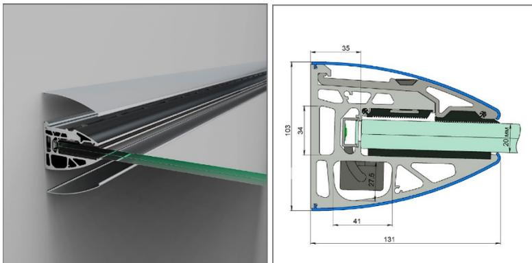
В стеклянном козырьке предусмотрена возможность установки подсветки, всё электрооборудование спрятана внутри профиля. В профиль помещается блок питания габаритов до Н=21мм x W=34мм, также короб со светодиодной лентой Н= 20мм x W= 11мм.
